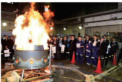
写真3 石油タンク火災の泡消火技術の実演
