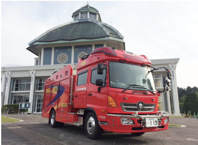
有田消防署に配置した救助資機材積載型水槽付消防ポンプ自動車
